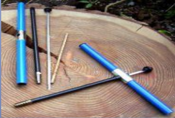
Succhiello di Pressler per la misura dell'età degli alberi in piedi
