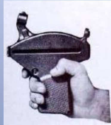
Ipsometro di Haga e ipsometro-telemetro elettronico per la misura delle altezze degli alberi in bosco
