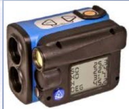
Ipsometro di Haga e ipsometro-telemetro elettronico per la misura delle altezze degli alberi in bosco
